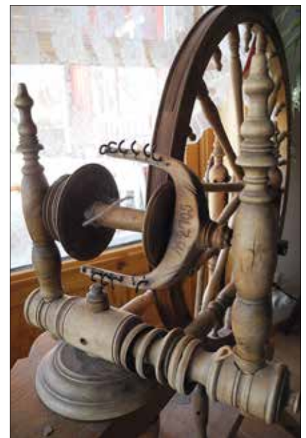
No 2705 står det på dette snelltyet. Legg merke til at «nokkan» (strengkrokane som tråden går over) er på same sida på dei to vengene. Dette er typisk for Knut Helland og bror hans, Hans. Eigar: Marte Trondsen. (Foto Bjørn Austigard)
