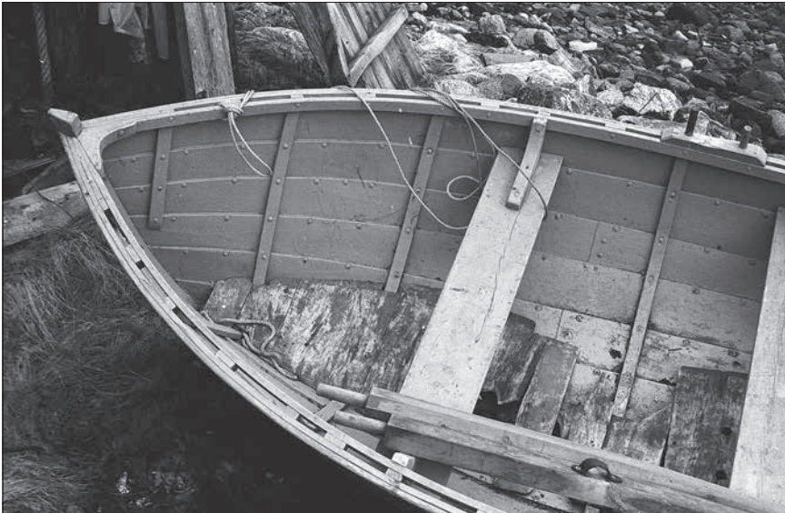
Fram til 1945 vart det bygd mange færingar av ore i Tresfjorden. Båtar av ore var lette og kunne derfor handterast av berre ein person, sa eigaren Gudrun Vestnes til meg i 1980. Legg merke til at banda (spanta) er tettare enn på ein færing av furu. (Foto Romsdalsmuseet)
