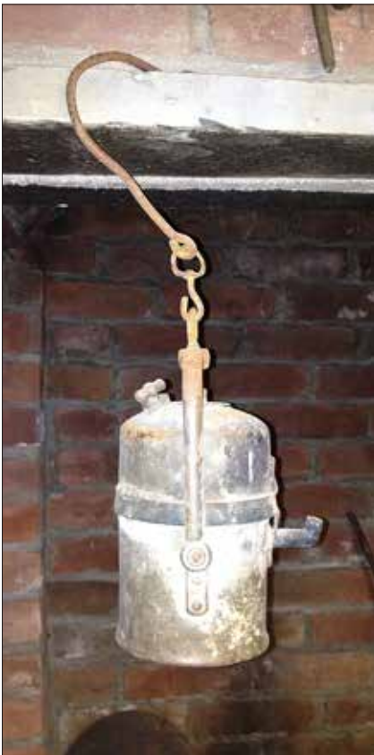
Gruvelykt frå Raudsand. Lykta har to behaldarar: Karbiden vart plassert i den nedste behaldaren og vatnet i den øvste. Når vatnet draup ned på karbiden, vart det laga gass. Drypinga kunne regulerast med skruen oppe t.v. Acetylenflammen stod ut frå brennaren midt på lykta t.h.
