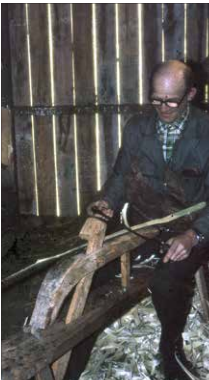
Bandstolen er konstruert for å «smie» (tønne)band. Med foten på ei trøe var det lett å halde bandet fast. På eit filmopptak i 1979 viste Håkon Vike korleis arbeidet vart gjort. (Foto Romsdalsmuseet)
