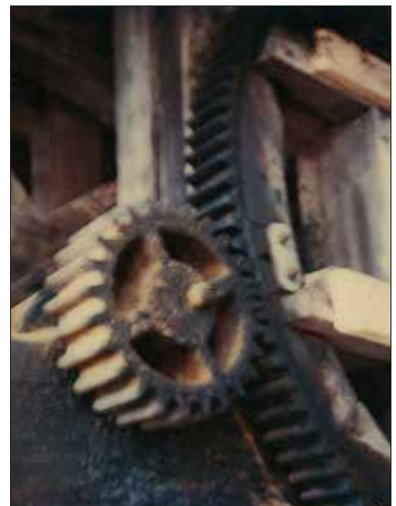
Tannhjul. For å få fart på sagbladet vart det nytta tannhjulsoverføring. Her burde kanskje Arbeidstilsynet vore på besøk? (Foto Romsdalsmuseet)
