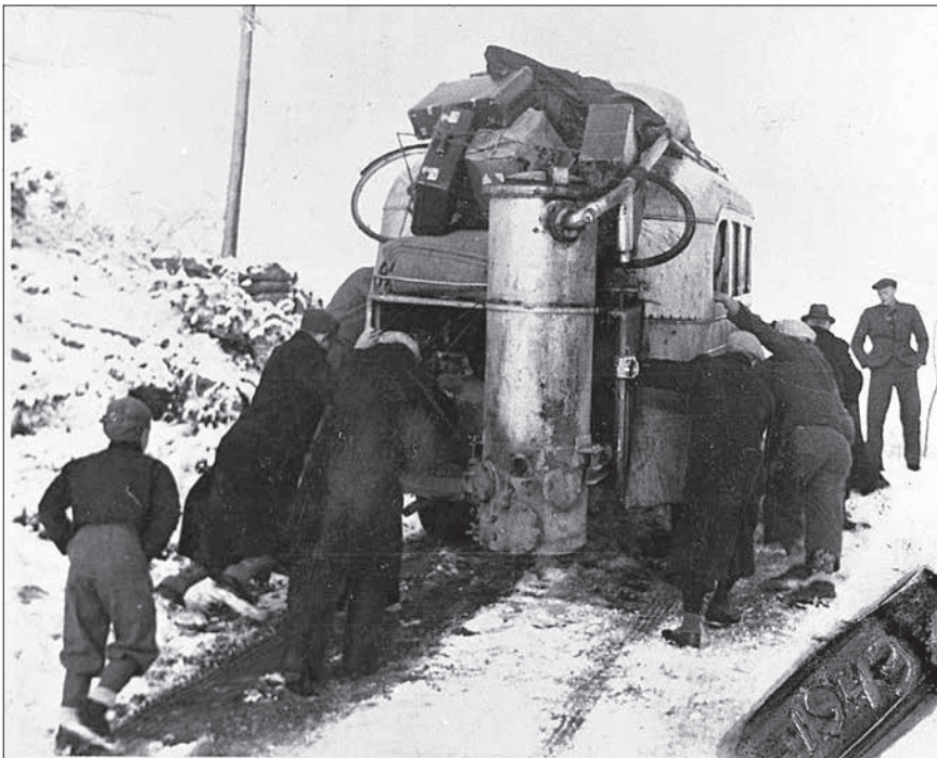
Chevrolet-buss med knott-generator 1943. Sjølv om or-knotten var full av energi, måtte det muskelkraft til når det kneip. Det var eigaren, Torbjørn Frisvoll, som tok dette historiske bildet av T-2935, bygd på Røvik karosserifabrikk 1936-37 og forlenga av Solheimdal under krigen. (Foto Romsdalsmuseet)
