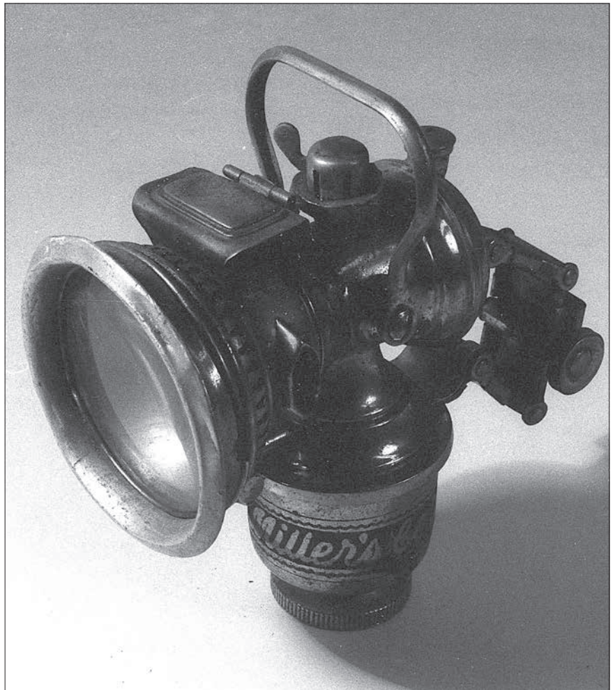
Karbidlykt brukt på sykkel, men det kan tenkjast at lykta også var tenkt for maritime forhold ettersom det er eit raudt og eit grønt prisme på kvar si side av flamma. (Foto Romsdalsmuseet)
