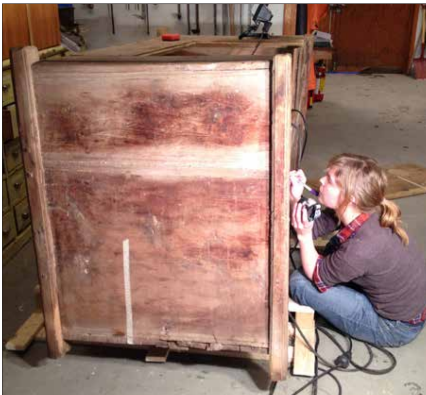
Helene Svarva frå NTNU i Trondheim tel her årringar på ei kornbøre (stolpekiste) frå Skalle i Kleive. Tverrenden er ferdig registrert, og der var det meir enn 350 vekstår. Etterpå fotograferte ho bordet (planken) med teipen på. Slik gjorde ho på ca. 10 stader. I eit laboratorium blir bildet kraftig forstørra, og slik kan vekstperioden avslørast. Laga kring år 1650. (Foto Bjørn Austigard/Romsdalsmuseet)
